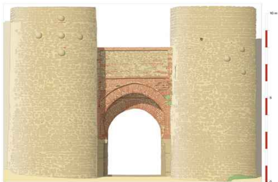
Restitución fotogramétrica del alzado exterior de la Puerta de Almocábar (Samuel Márquez Bueno)
